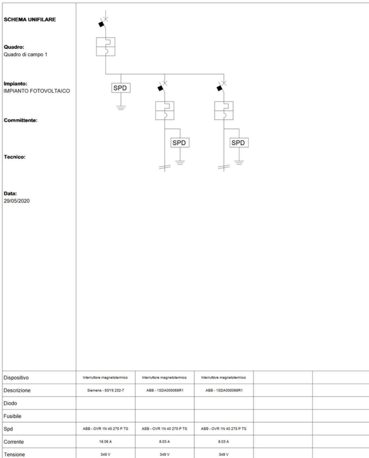
Fig. 7: Schema unifilare quadro "Quadro di campo 1"
