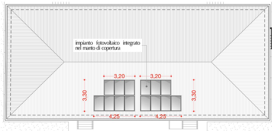
Fig. 4: Posizionamento dei moduli del generatore Generatore1
