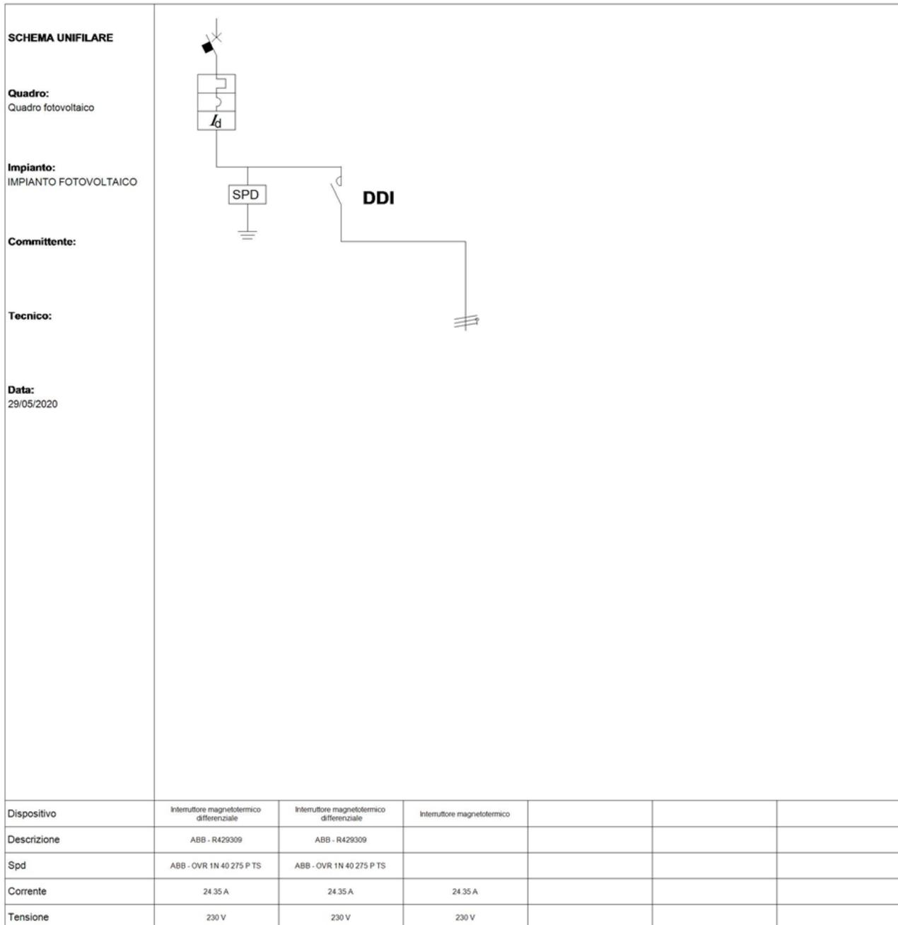
Fig. 6: Schema unifilare quadro "Quadro fotovoltaico"
