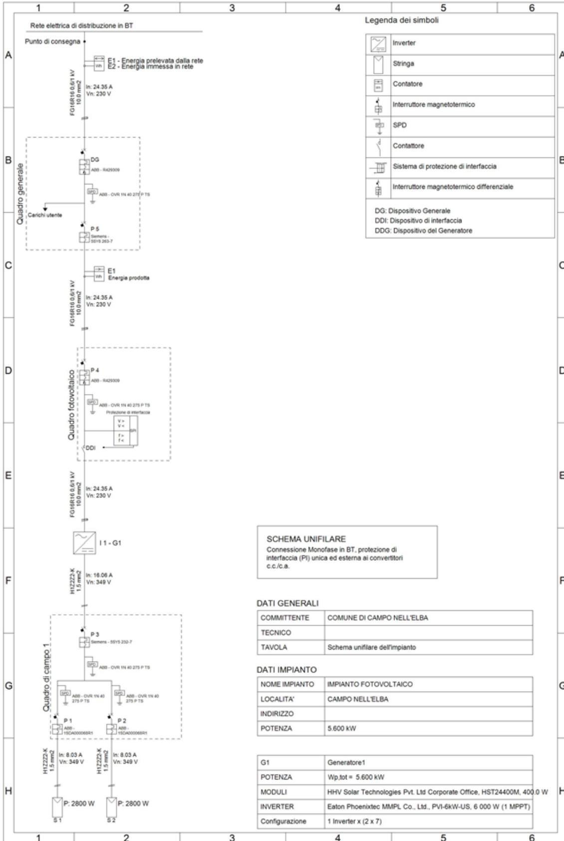
Fig. 8: Schema elettrico unifilare dell'impianto
